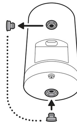
カメラマウントをカメラ背面に取り付け、ネジで固定します。
