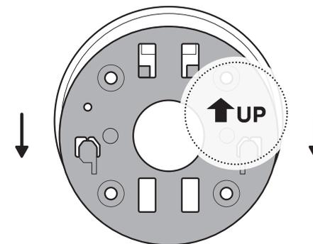
取付プレートを設置位置の壁に押し当て、ネジ穴の位置に印を付けます。
