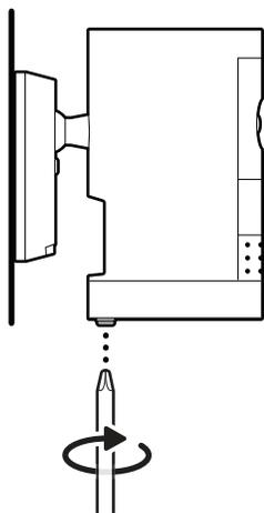
(オプション) カメラの位置を調整した後、カメラマウントの底部にあるゴムキャップを取り外し、ネジを締めてしっかりと固定します。ゴムキャップを再度取り付けます。
