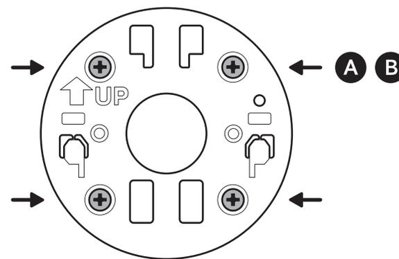
漆喰やレンガ、コンクリートなどの硬い表面に設置する場合は、1/4インチ (6mm) の石材用ドリルビットを使用して下穴を開け、付属の壁面用アンカーを差し込みます。
