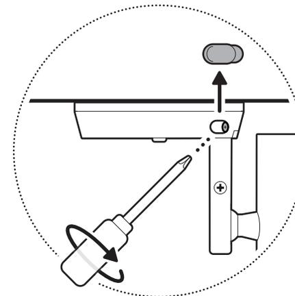
カメラの角度を調整し、カメラマウントアームのネジを締めてしっかりと固定します。
