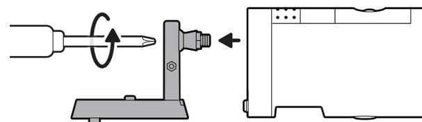
カメラ背面のゴムキャップを取り外し、底部にはめ込みます。
