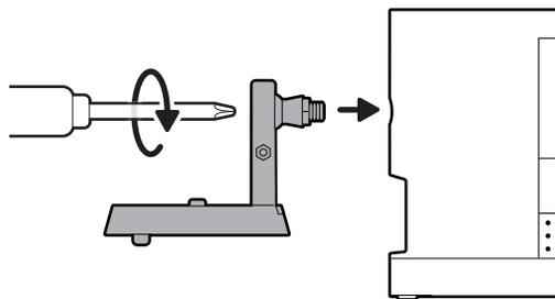
カメラマウントのベース部分を元の位置に戻し、カメラを取付プレートに取り付け、カチッと音がするまでスライドさせて固定します。
