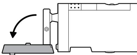
ネジを外して、バッテリーカバーからカメラマウントを取り外します。
