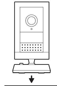
**注:** カメラの角度を下向きに調整する場合は、ベース部分の長辺を正面に向けて、カメラを下に傾けてください。
