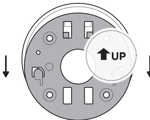
取付プレートを設置位置の壁に押し当て、ネジ穴の位置に印を付けます。
