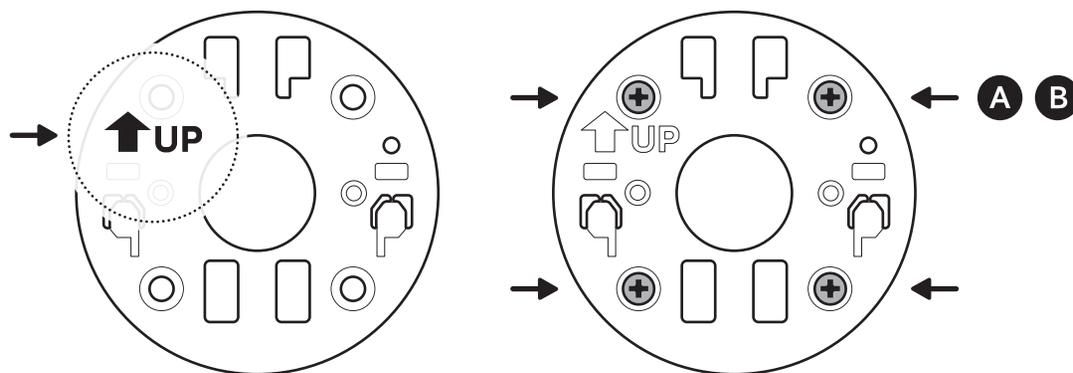
漆喰やレンガ、コンクリートなどの硬い表面に設置する場合は、1/4インチ (6mm) の石材用ドリルビットを使用して下穴を開け、付属の壁面用アンカーを差し込みます。
