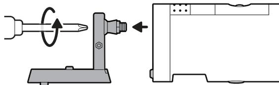
カメラ背面のゴムキャップを取り外し、底部にはめ込みます。
