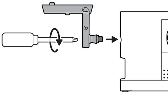
カメラを取付ブラケットに取り付け、「カチッ」と音がするまでスライドさせて固定します。
