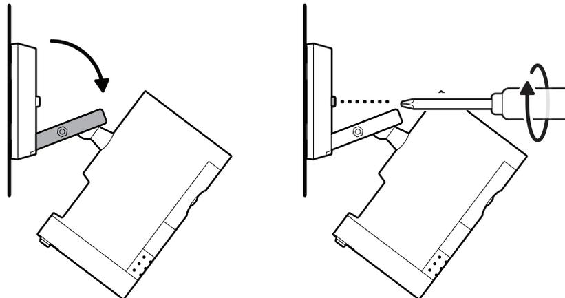
バッテリーカバーの安全ネジを締めます。
