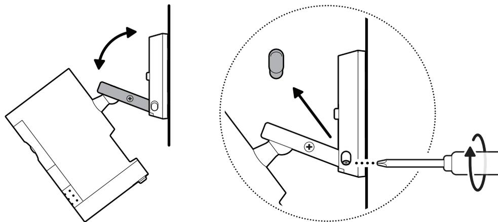
カメラの角度を調整し、カメラマウントアームのネジを締めてしっかりと固定します。
