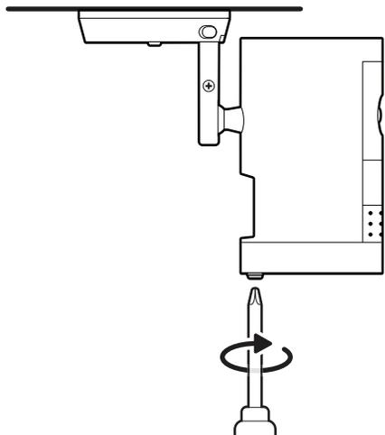
(オプション) カメラの位置を調整した後、カメラマウントの底部にあるゴムキャップを取り外し、ネジを締めてしっかりと固定します。ゴムキャップを再度取り付けます。
