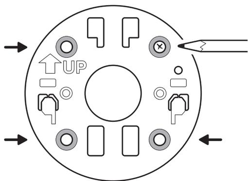
「UP」矢印が上を向くように、取付プレートを取り付けます。
