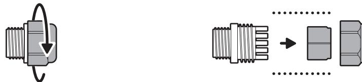
5. Faites passer le câble Ethernet dans le presse-étoupe, en enroulant le joint torique autour du câble, et serrez-le jusqu'à ce qu'il soit bien étanche.
