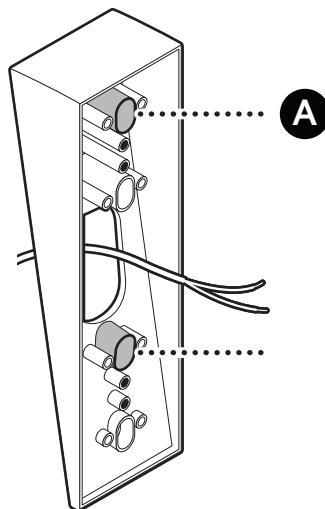
En estuco, ladrillo u hormigón, utiliza una broca de albañilería de 6 mm para perforar los orificios en los que irán introducidos los tacos de pared incluidos.
