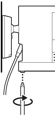
11. Undeclare the camera mount and tighten the security screw. / Ouvrir le support de la caméra. Serrer la vis de sécurité. / Desengancha el montaje de la cámara y ajusta el tornillo de seguridad.
