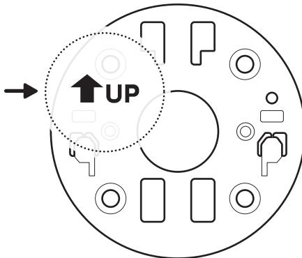
On stucco, brick, or concrete, use a 1/4 in (6 mm) masonry bit to drill holes for the included wall anchors. / Sur le stuc, la brique ou le béton, utiliser un foret de maçonnerie de 1/4 po (6 mm) pour percer des trous et y insérer les ancrages murales fournis. / En estuco, ladrillo o concreto, usa una broca de taladro de 1/4" (6 mm) a fin de perforar agujeros para los anclajes de pared incluidos.
