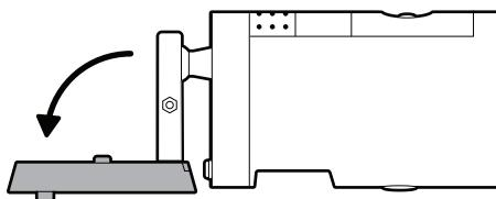
5. Unscrew to detach the camera mount from the battery cover. / Dévisser pour détacher le support de la caméra du couvercle du compartiment de la batterie. / Desatornilla para soltar el montaje de la cámara de la cubierta de la batería.
