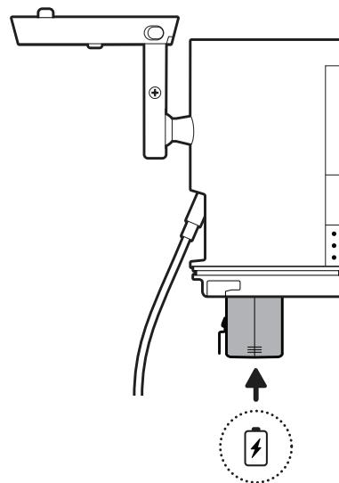
9. Secure your camera to the mounting plate by sliding until you feel a click. / Fixer la caméra à la plaque de montage en la faisant glisser jusqu'à ce que vous entendiez un clic. / Fija la cámara en la placa de montaje. Para ello, deslízala hasta que escuches un clic.
