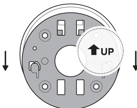
2. Use the mounting plate as a guide to mark screw holes on the ceiling. / Utiliser la plaque de fixation comme guide pour marquer les trous de vis au plafond. / Utiliza la placa de montaje como guía para marcar los orificios de los tornillos en el techo.
