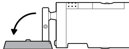
5. Unscrew to detach the camera mount from the battery cover. / Dévisser pour détacher le support de la caméra du couvercle du compartiment de la batterie. / Desatornilla para soltar el montaje de la cámara de la cubierta de la batería.
