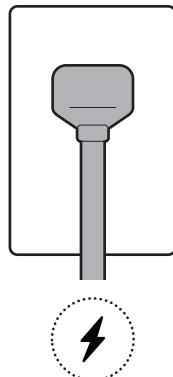
14. Anchor the power cable to the wall or ceiling with the included cable clips. / Attacher le câble d'alimentation au mur ou au plafond avec les serre-câbles inclus. / Ancla el cable de alimentación a la pared o al techo con las abrazaderas de cables incluidas.
