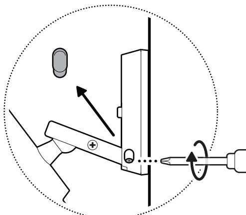
12. Adjust your camera's angle, then tighten the screw on the camera mount arm to secure in place. / Ajuster l'angle de la caméra, puis serrer la vis sur le bras du support de la caméra pour la fixer. / Ajusta el ángulo de la cámara y, luego, ajusta el tornillo del brazo de montaje de la cámara para asegurarla en su lugar.
