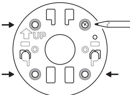
3. Install the mounting plate with the UP arrow pointing up. / Installer la plaque de montage avec la flèche orientée vers le haut. / Instala la placa de montaje con la flecha apuntando hacia arriba.
