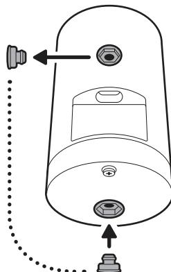
7. Attach the camera mount to the back of your camera with its screw. / Attacher le support à caméra à l'arrière de celle-ci avec la vis intégrée au support. / Conecta el montaje de la cámara a la parte trasera de la cámara con su tornillo.
