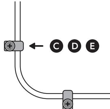
(Optional) Secure the power adapter with the included anchors and screws. / (Facultatif) Fixer l'adaptateur de courant avec les vis et les ancrages inclus. / (Opcional) Fija el adaptador de corriente con los anclajes y tornillos incluidos.
