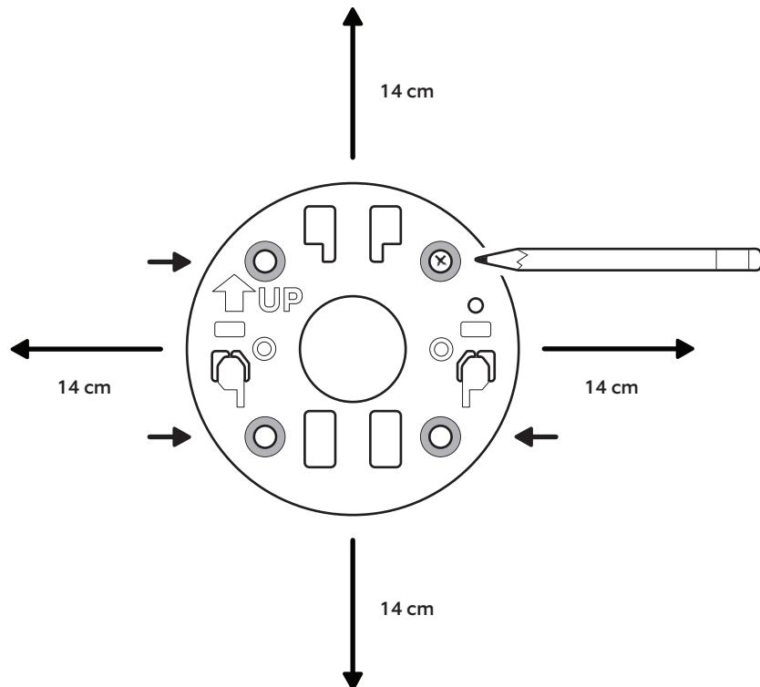
3. رُكِّب رافعة التثبيت مع توجيه السهم UP لأعلى نحو اتجاه العرض المطلوب على الجص أو الطوب أو الخرسانة. استخدم قطعة حفر إسمنت بقياس 5 مم لإحداث الثقوب لتعليق ركائز الجدار المضمنة.
