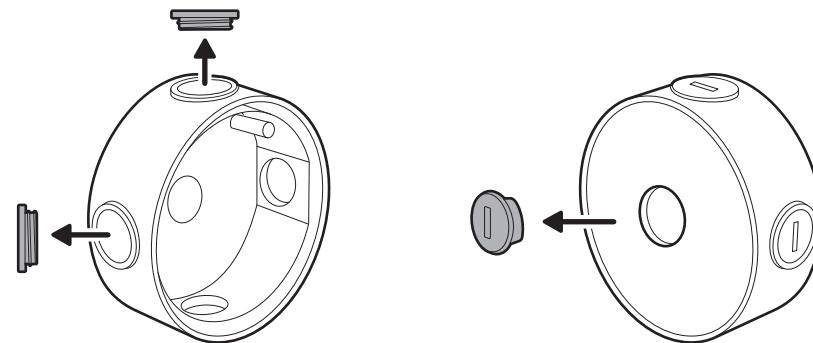
2. ثبّت صندوق الكهرباء المرفق على الحائط أو السقف باستخدام المسامير المرفقة. على الحص أو الطوب أو الخرسانة، استخدم قطعة حفر اسمنت بقياس 5 مم لإحداث الثقوب لتعليق ركائز الجدار المضمنة.
