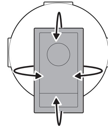
24. يجب وضع السيليكون أو السد المناسب حول أغطية صندوق الكهرباء القابلة للنزع، وبين صندوق الكهرباء وحامل غطاء صندوق الكهرباء، وبين صندوق الكهرباء وسطح التثبيت لإغلاق أي فجوات.
