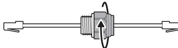
ملاحظة: إذا قمت بتنبيت صندوق الكهرباء مباشرة فوق مفتاح الطاقة عبر إيثرنت (PoE) الخاص بك، فلن تحتاج إلى إرفاق عروة ربط الكابل.
