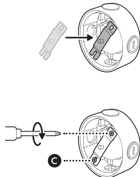
11.أغلق صندوق الكهرباء باستخدام حامل الخطاء.
