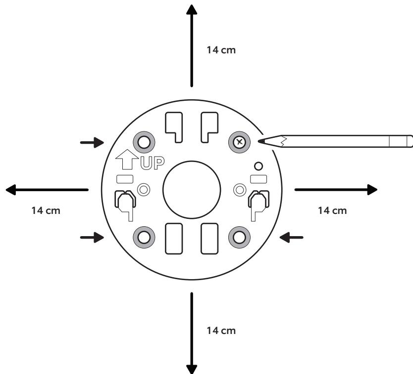
ركب رافعة التثبيت مع اتباع اتجاه السهم UP ليكون للأعلى على الجص أو الطوب أو الخرسانة. استخدم قطعة حفر إسمنت بقياس 5 مم لإحداث الثقوب لتعليق ركائز الجدار المضمنة.
