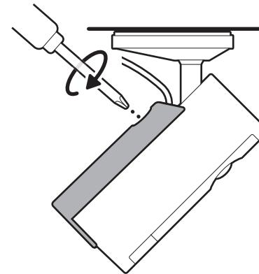
11. ثبّت المحول على الحائط أو السقف باستخدام المسامير المرفقة على الجص أو الطوب أو الخرسانة. استخدم قطعة حفر إسمنت بقياس 5 مم لإحداث الثقوب لتعليق ركائز الجدار المضمونة مع المحول.
