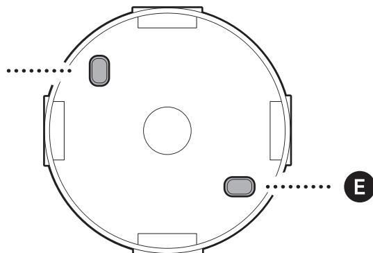
En estuco, ladrillo u hormigón, utiliza una broca de albañilería de 6 mm para perforar los orificios en los que irán introducidos los tacos de pared incluidos.
