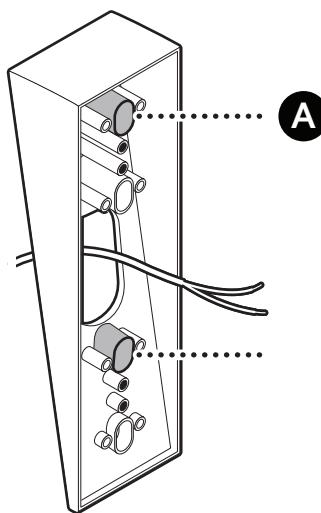
على الجص أو الطوب أو الخرسانة. استخدم رأس لنقب البناء بقياس 6 مم لحفر الثقوب لمثبتات الحائط المضمنة.
