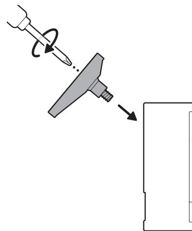
7. カメラを取り付けプレートに取り付け、カチッと音がするまでスライドさせて固定します。
