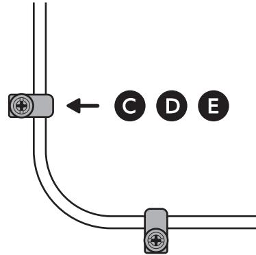
13. 付属のアンカーとネジで電源アダプターを固定します。
