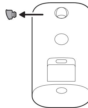
6. カメラマウントをカメラ背面に取り付け、ネジで固定します。
