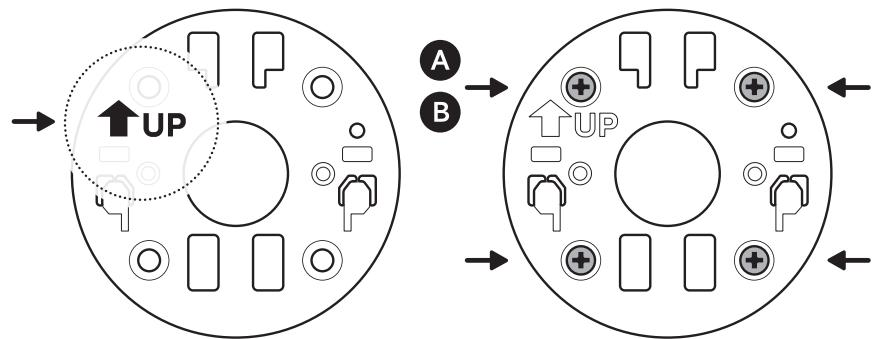
漆喰やレンガ、コンクリートなどの硬い表面に設置する場合は、5mm (3/16インチ) の石材用ドリルビットを使用して壁に穴を開け、付属の壁面用アンカーを差し込みます。
