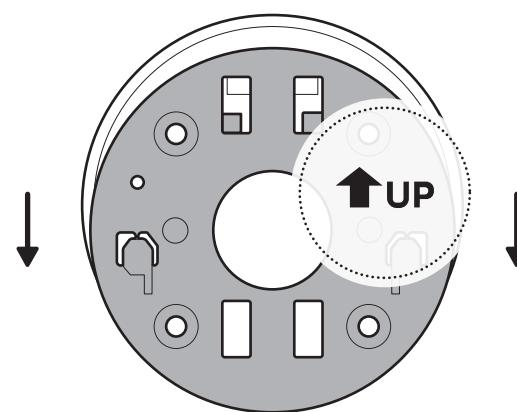
2. 取り付けプレートを壁の設置位置に押し当て、周囲に14cm (5.5インチ) 以上の間隔を空けてから、ネジ穴の位置に印を付けます。
