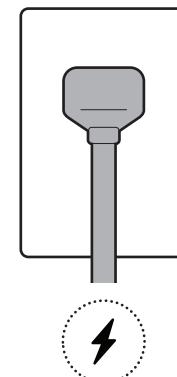
12. 付属のケーブルクリップで電源ケーブルを壁または天井に固定します。
