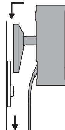
9. カメラを回転させ、安全ネジを締めます。
