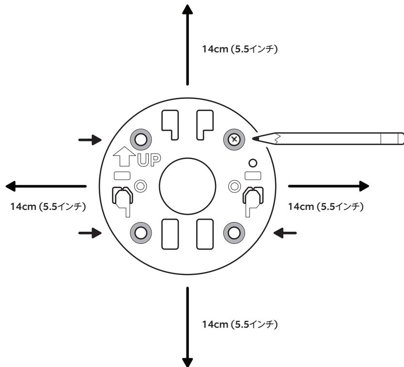
3. 「UP」矢印が上を向くように、取り付けプレートを取り付けます。
