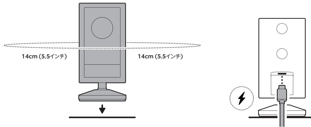
注: カメラの角度を下向きに調整する場合は、ベース部分の長辺を正面に向けて、カメラを下に傾けてください。
