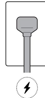
11. 付属のケーブルクリップで電源ケーブルを壁または天井に固定します。
