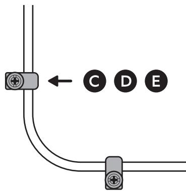
12. 付属のアンカーとネジで電源アダプターを固定します。
