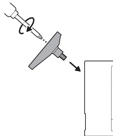
7. Fissare la videocamera alla piastra di montaggio facendola scorrere fino a quando non scatta in posizione.
