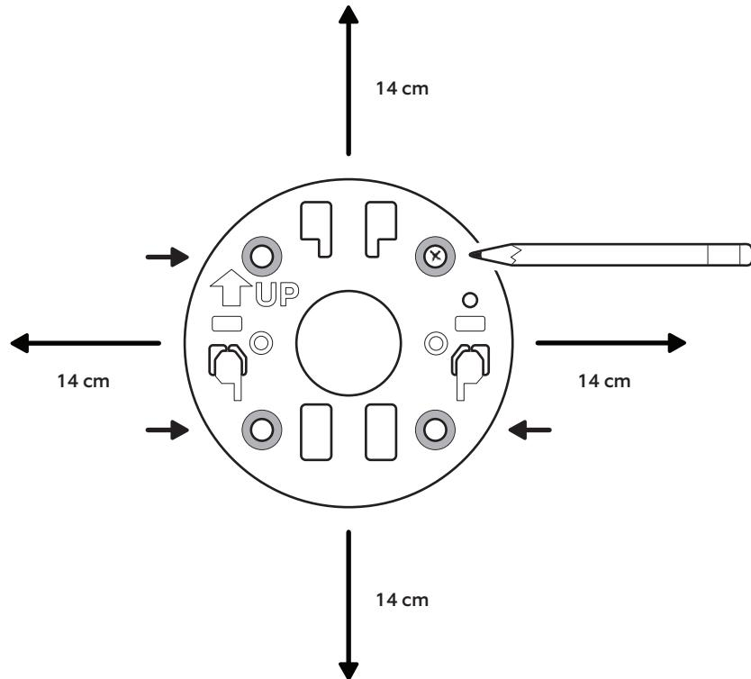
3. Installare la piastra di montaggio con la freccia UP rivolta nella direzione della visuale desiderata. Per superfici in stucco, mattoni o cemento, utilizzare una punta da trapano per muratura da 5 mm per praticare i fori per i tasselli forniti a corredo.
