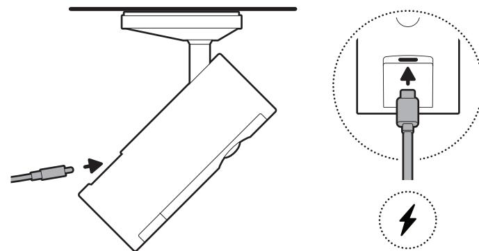
10. Far scorrere la staffa per il cavo inclusa sul retro della videocamera e stringere la vite per fissare il cavo di alimentazione.
