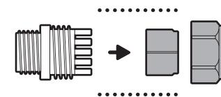
5. Infilare il cavo Ethernet nel pressacavo, avvolgendo la guarnizione attorno al cavo e avvitare saldamente fino a ottenere una tenuta sicura.
