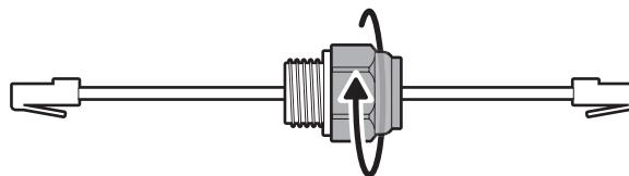
**NOTA:** se si installa la scatola di giunzione direttamente sullo switch PoE, non occorre fissare il pressacavo.
