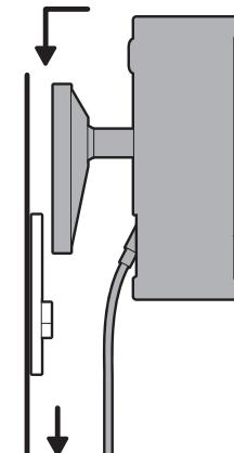
9. Ruotare la videocamera e serrare la vite di sicurezza.
