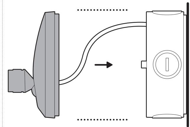
12. Serrare la vite centrale per fissare in posizione il supporto del coperchio della scatola di giunzione.
