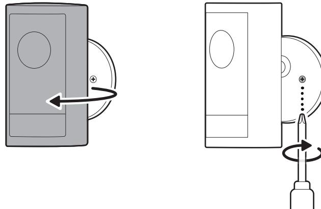
10. Installare l'adattatore alla parete con le viti in dotazione. Per superfici in stucco, mattoni o cemento, utilizzare una punta da trapano per muratura da 5 mm per praticare i fori per i tasselli forniti a corredo.
