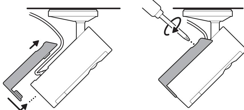
11. Installare l'adattatore alla parete o al soffitto con le viti in dotazione. Per superfici in stucco, mattoni o cemento, utilizzare un trapano con punta per muratura da 5 mm per praticare i fori per i tasselli forniti in dotazione con l'alimentatore.
