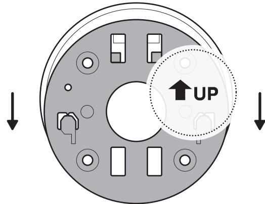
2. Utilizzare la piastra di montaggio come guida per contrassegnare i fori per le viti sul soffitto lasciando uno spazio di 14 cm su ogni lato.
