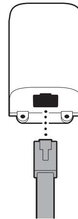
8. Collegare il cavo USB-C all'interno del supporto del coperchio della scatola di giunzione all'adattatore, assicurandosi che sia completamente inserito.
