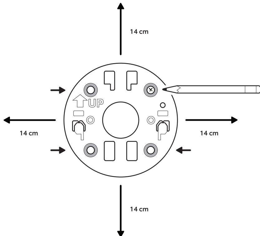
3. Posizionare la piastra di montaggio con la freccia UP rivolta verso l'alto. Per superfici in stucco, mattoni o cemento, utilizzare una punta da trapano per muratura da 5 mm per praticare i fori per i tasselli forniti a corredo.
