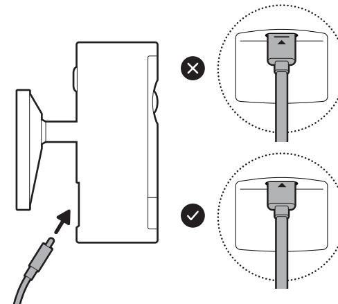
8. Fissare la videocamera alla piastra di montaggio facendola scorrere fino a quando non scatta in posizione.
