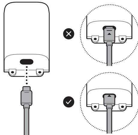
13. Stecken Sie das Ethernet-Kabel in den Adapter.
