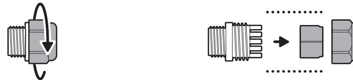
5. Führen Sie das Ethernet-Kabel durch die Kabelverschraubung,wickeln Sie den O-Ring um das Kabel und schrauben Sie es fest, bis es sicher sitzt und abgedichtet ist.
