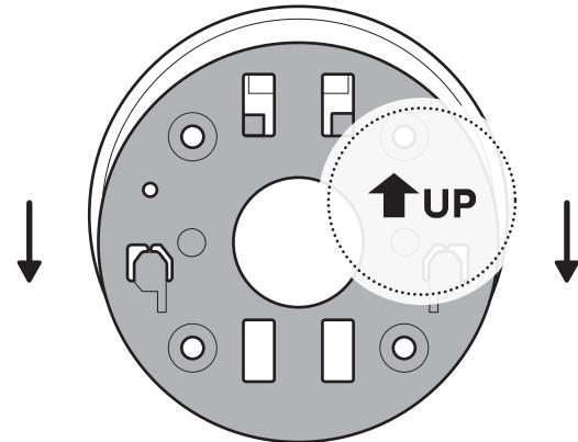
Verwenden Sie die Montageplatte als Orientierung, um Bohrlöcher an der Decke zu markieren. Halten Sie einen Abstand von 14 cm in alle Richtungen ein.
