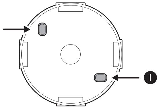
4. Öffnen Sie die Kabelverschraubung, indem Sie die Kappe vom Gehäuse abschrauben.
