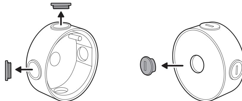
2. Montieren Sie die enthaltene Abzweigdose mit den mitgelieferten Schrauben an der Wand oder Decke. Bohren Sie bei der Montage auf Putz, Ziegelstein oder Beton mit einem 5 mm dicken Steinbohrer Löcher für die enthaltenen Wanddübel.
