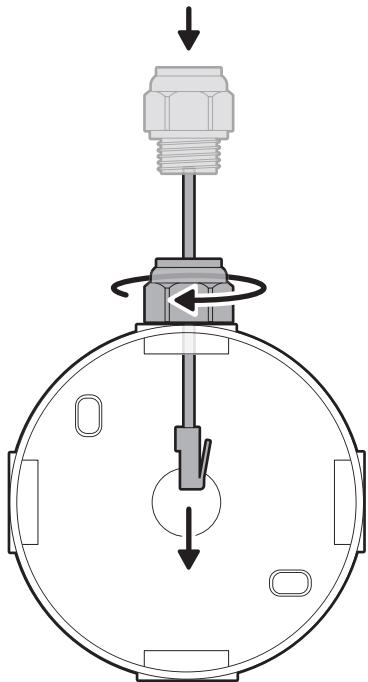
7. Stecken Sie das Ethernet-Kabel in den Adapter.
