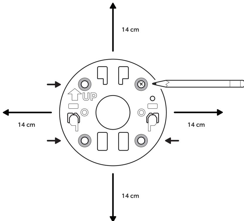
3. Platzieren Sie die Montageplatte so an der Wand, dass der Pfeil „UP“ nach oben zeigt. Bohren Sie bei der Montage auf Putz, Ziegelstein oder Beton mit einem 5 mm dicken Steinbohrer Löcher für die enthaltenen Wanddübel.
