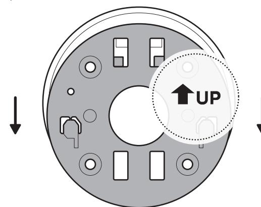
2. Verwenden Sie die Montageplatte als Orientierung, um Bohrlöcher an der Wand zu markieren. Halten Sie einen Abstand von 14 cm in alle Richtungen ein.
