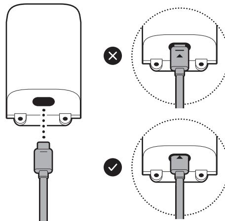
4. Stecken Sie das andere Ende des USB-C-Kabels in die Kamera, bis die Markierungslinie nicht mehr zu sehen ist.
