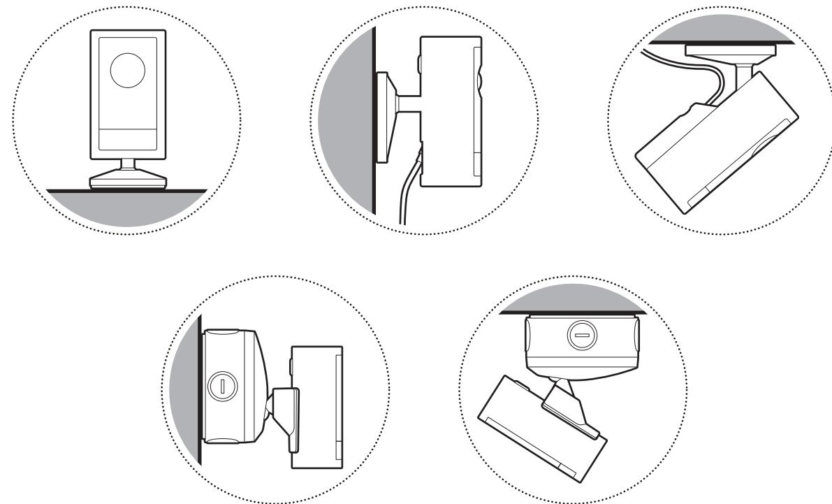
**HINWEIS:** Stellen Sie vor der Montage sicher, dass Ihr PoE+ fähiger PoE-Switch (Power-over-Ethernet) aktiv und an ein funktionierendes Ethernet-Kabel der Kategorie 5 angeschlossen ist.
