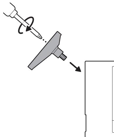
7. Befestigen Sie die Kamera an der Montageplatte, indem Sie sie einschieben, bis sie spürbar einrastet.
