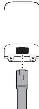
8. Stecken Sie das USB-C-Kabel der Montageabdeckung für die Abzweigdose in den Adapter und stellen Sie sicher, dass es vollständig eingesteckt ist.
