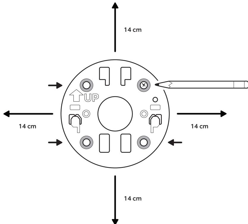
3. Montieren Sie die Montageplatte so, dass der Pfeil „UP“ in die gewünschte Blickrichtung der Kamera zeigt. Bohren Sie bei der Montage auf Putz, Ziegelstein oder Beton mit einem 5 mm dicken Steinbohrer Löcher für die enthaltenen Wanddübel.
